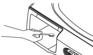
**Bac à détergent** : Il est possible qu'il y ait des accumulations de détergent et d'assouplissant dans le bac à détergent. Il convient d'éliminer ces résidus une à deux fois par mois.
