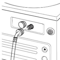
3. Branchez les extrémités du tuyau d'arrivée au robinet d'eau FROIDE et serrez le raccord à la main, puis complétez le serrage en serrant à nouveau sur 2/3 de tour à la pince. Allumez l'eau et vérifiez l'absence de fuite.
