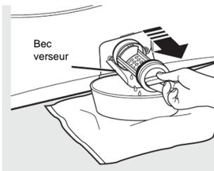
4. Tournez le filtre de la pompe dans le sens inverse des aiguilles d'une montre, puis retirez le filtre. Procédez lentement pour laisser l'eau s'évacuer.
