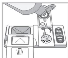
1. Ouvrir le réservoir « D » en poussant et en soulevant la languette sur le couvercle ;
