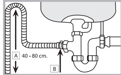
Avant de raccorder le tuyau d'évacuation de l'eau au siphon de l'évier, retirer le bouchon en plastique (B).
