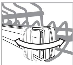
Ouvrir les butées installées à droite et à gauche et sortir le panier.
