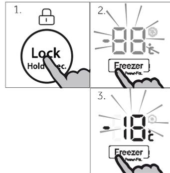
Le réglage confirme automatiquement le non-fonctionnement d'une touche après 5 secondes.
