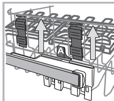
Si le panier est équipé de **Lift-Up\*** (voir figure), soulever le panier en le saisissant par les côtés et le déplacer vers le haut. Pour revenir à la position basse, appuyer sur les leviers (A) sur les côtés du panier et l'aider à descendre vers le bas.
