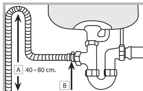
Avant de raccorder le tuyau d'évacuation de l'eau au siphon de l'évier, retirer le bouchon en plastique (B).
