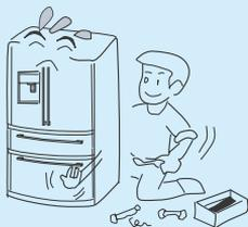
Lorsque le réfrigérateur doit être mis au rebut, démontez la porte, le joint de la porte et les clayettes, puis placez-les dans un endroit adéquat pour éviter que les enfants n'entrent dans le réfrigérateur et ne causent un accident.
