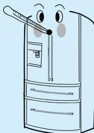
Lorsque le réfrigérateur fonctionne pendant une période prolongée, la température de la surface du montant vertical installé sur la porte gauche du compartiment de réfrigération et celle du corps de la porte augmente. Ce phénomène est normal et il a principalement été conçu pour éviter toute condensation.
