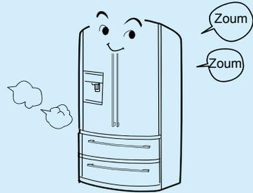
En cas de changement de température lors du fonctionnement du réfrigérateur, les articles placés dans le réfrigérateur peuvent se dilater ou se contracter, de telle sorte que des crépitements peuvent provenir de l'évaporateur et des tuyaux.
