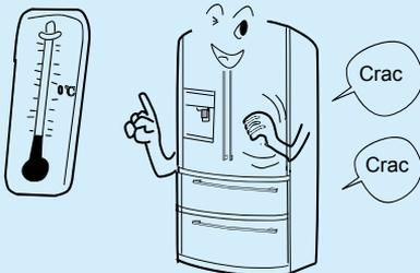
Un crépitement est un bruit normal lorsque le compresseur fonctionne ou lors du démarrage du réfrigérateur ou de l'ouverture de sa porte.
