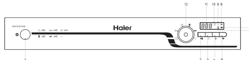
1. Bouton d'alimentation : permet de mettre l'appareil sous tension ou hors tension.
