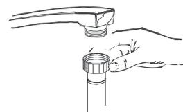
Raccorder le tuyau d'eau froide à un embout fileté 1,90 cm (3/4 inch) et s'assurer qu'il est fermement attaché. Si les canalisations d'eau sont neuves ou n'ont pas été utilisées durant une longue période de temps, laisser l'eau couler pour s'assurer que l'eau est claire et sans impureté. Si cette précaution n'est pas prise, il y a un risque de blocage de l'arrivée d'eau et d'endommagement de la machine.
