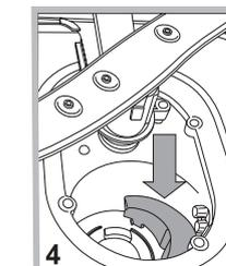
Après avoir nettoyé les filtres, remettre soigneusement le groupe filtrant à sa place, cette opération est fondamentale pour un bon fonctionnement du lave-vaisselle.
