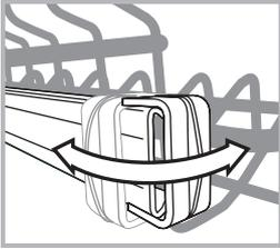
Ouvrir les butées installées à droite et à gauche et sortir le panier. Lorsque le panier supérieur a été inséré, les butées doivent être toujours fermées.
