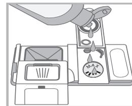
1. Ouvrir le réservoir « **D** » en poussant et en soulevant la languette sur le couvercle ;
