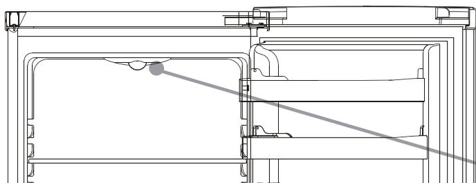
Le thermostat commandant l'appareil se trouve en haut à droite à l'intérieur du réfrigérateur. Pour vérifier que l'appareil fonctionne, assurez-vous que le bouton du thermostat ne se trouve pas en position "0".
