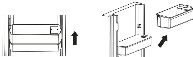
2. Démontez le bassin d'eau. Détachez la couverture en haut et nettoyez le bassin et la couverture.
