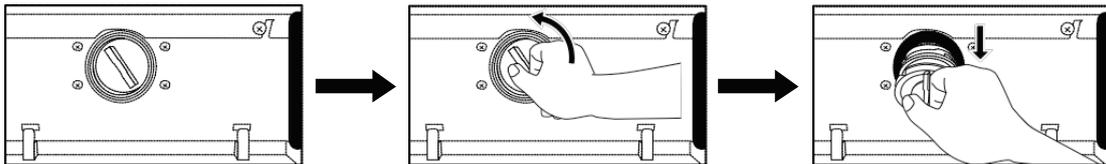
5. Tournez le filtre dans le sens des aiguilles d'une montre afin de le revisser. Fermez le volet d'entretien.
