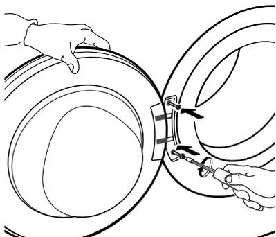
**6.** Insérez le verrou de porte sur le côté droit de l'ouverture de porte. Appuyez dessus totalement à l'intérieur du trou et déplacez-le légèrement vers le bas, jusqu'à ce que le petit bouton du verrou de porte s'enclenche.
