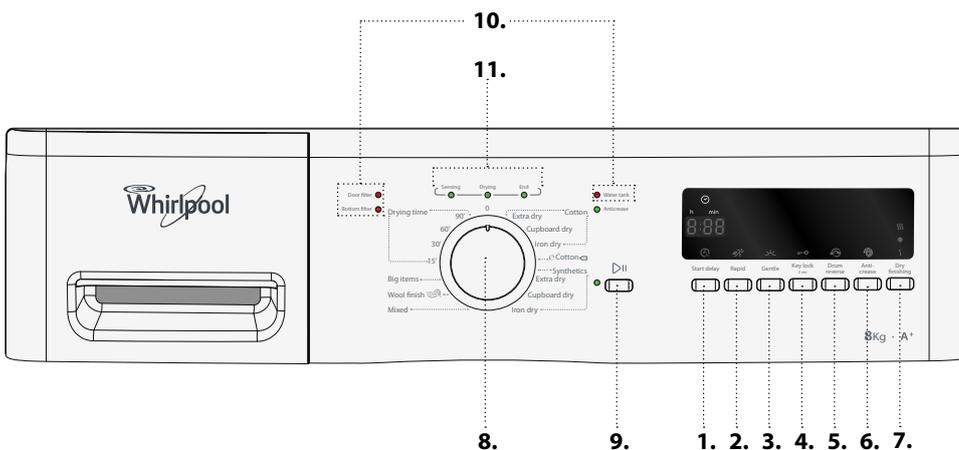
1. Start delay function / Fonction Départ différé
