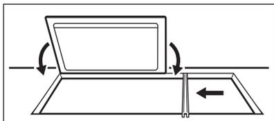
7. Vissez légèrement les plaques de fixation par en dessous au plan de travail et à la barre d'accouplement.
