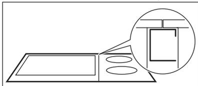
8. Insérez la table de cuisson suivante dans la découpe du plan de travail. Veillez à ce que les bords avant des tables de cuisson soient au même niveau.
