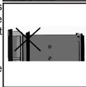
6. Remettez correctement le condenseur en place (en suivant la flèche) en le poussant fermement. Bloquez les deux leviers en position en les tournant dans le sens des aiguilles d'une montre. Repositionnez le joint dans la gorge si il est mal aligné.
