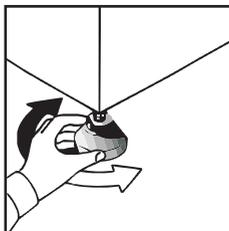
**6.** Une fois la machine en place, ajustez les pieds de façon à ce que le tuyau de se coince pas sous la machine.
