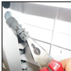
**2.** Le tuyau d'eau sales se trouve du côté droit de la machine (voir ci-contre). Un tuyau gris est branché sur le raccord sur le côté gauche. A l'aide d'une pince, retirez l'étrier de fixation du tuyau de raccord.
