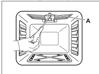
2. Desserrez l'injecteur du brûleur à l'aide d'une clé à douille de 7 mm et remplacez-le.
