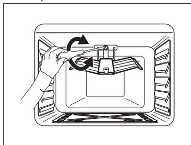
3. Remontez le brûleur en suivant les instructions dans l'ordre inverse. Avant de serrer la vis, assurez-vous que le brûleur est correctement enfoncé dans le panneau arrière. Testez les injecteurs du grill.
