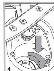
Après avoir nettoyé les filtres, remettre soigneusement le groupe filtrant à sa place, cette opération est fondamentale pour un bon fonctionnement du lave-vaisselle.
