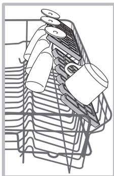
Les verres à pied peuvent être placés en position stable sur les clayettes rabattables en insérant la tige de leurs pieds dans les fentes prévues à cet effet.
