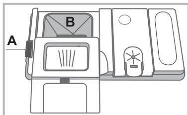
Introduire le produit de lavage dans le bac « B » bien sec. La quantité de produit de lavage consacrée au pré-lavage doit être placée directement dans la cuve.
