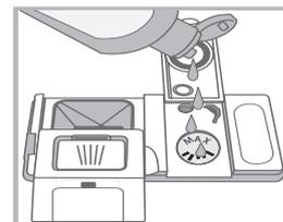
1. Ouvrir le réservoir « **D** » en poussant et en soulevant la languette sur le couvercle ;
