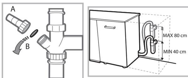
Avant de raccorder le tuyau d'évacuation de l'eau au siphon de l'évier, retirer le bouchon en plastique (B).
