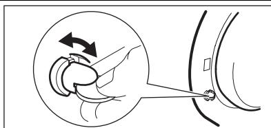
Lorsque ce dispositif est activé, vous ne pouvez pas fermer le hublot. Cela évite d'enfermer un enfant ou un animal dans l'appareil par accident. Pour activer ce dispositif, tournez-le vers la droite, jusqu'à ce que la rainure soit horizontale. Pour désactiver ce dispositif, tournez-le vers la gauche, jusqu'à ce que la rainure soit verticale.
