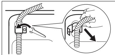
5. Placez les extrémités du tuyau de vidange et du tuyau d'arrivée d'eau dans un récipient. Laissez l'eau s'écouler des tuyaux.
