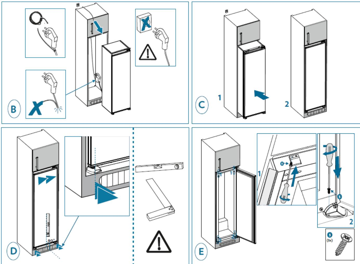
5. Vissez un guide dans les trous du côté de l'appareil. Insérez la glissière dans le guide et vissez-là à la porte. Dévissez le guide pour visser la dernière vis de la glissière sur la porte. Fixez ensuite le cache de la glissière sur la glissière. Vissez à nouveau le guide sur l'appareil en y insérant la glissière.
