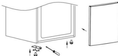
7. Installez la charnière centrale sur le côté gauche, puis installez la porte du réfrigérateur en même temps.
