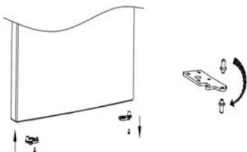
5. Retirez le cache-trou de la charnière droite du congélateur, installez-le sur le côté gauche. Retirez la cheville de trou de vis de la charnière centrale située sur le côté gauche, puis installez-la à droite.
