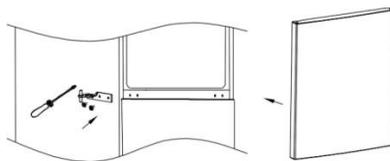
8. Retirez le cache-trou gauche de la charnière sur le côté droit, puis installez la charnière supérieure et le couvercle de charnière du côté gauche de l'armoire.
