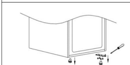
4. Retirez le butoir de la porte droite situé en bas de la porte du réfrigérateur et du congélateur, puis retirez le butoir de la porte gauche du sac d'accessoires, installez-le sur le côté inférieur gauche de la porte du réfrigérateur et du congélateur. Retirez la tige et installez-la de l'autre côté.
