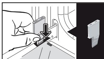
Irrota ensimmäinen napsautettu lasi: Irrota lasi klipsikiinnityksistään käyttämällä toista **A** kiilaa (tai ruuvimeisseliä). Irrota lasi.
