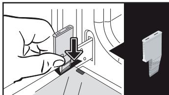
Αφαιρέστε το πρώτο στρεωμένο τζάμι: Χρησιμοποιώντας το άλλο στοπ (ή ένα κατσαβίδι), ασκήστε πίεση στις υποδοχές
