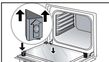
Após a limpeza, reposicione os quatro batentes de borracha com a seta virada para cima e reposicione o conjunto dos vidros.
