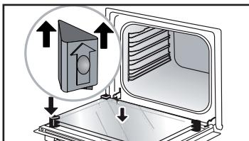
Sätt efter rengöring tillbaka de fyra gummibussningarna med pilen uppåt och sätt tillbaka samtliga glasrutor.
