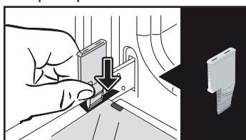
Извлеките первое закрепленное стекло: с помощью другого клина (или отвертки) нажмите на места закрепления **A**, чтобы
