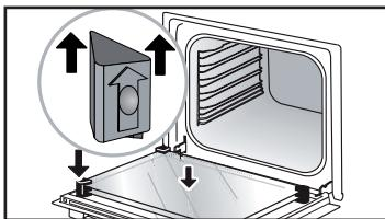
Tisztítás után helyezze vissza a négy gumiütközőt a nyilakkal felfelé, és helyezze vissza az ablakszerelvényt.
