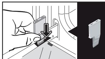
Entfernen Sie die erste mit Clip befestigte Scheibe: Drücken Sie mithilfe des anderen Keils (oder eines Schraubendrehers) gegen die Einbaupositionen **A**, um die mit Clip befestigte Scheibe zu entfernen. Entfernen Sie die Scheibe. Die Tür besteht aus zwei
