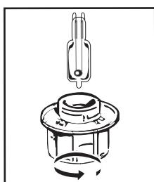
**Nefunkční žárovku můžete vyměnit sami.** Pro odšroubování ochranného skla a žárovky použijte kaučukovou rukavici, která usnadní vymontování. Vložte novou žárovku a znova nasadte ochranné sklo.
