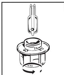
**Voit vaihtaa toimimattoman lampun itse.** Kierrä suojalasi irti ja irrota valo (käytä kumikäsintä helpottamaan valon suojalasin irrottamista). Aseta uusi valo paikalleen ja suojalasi paikalleen.
