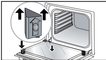
Zet na het reinigen de vier rubber blokjes terug met de pijl naar boven en zet alle ruiten weer terug.
