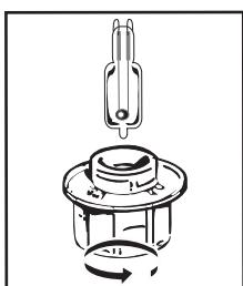
Μπορείτε να αντικαταστήσετε εσείς τη λυχνία, εάν δεν λειτουργεί πλέον. Ξεβιδώστε το κάλυμμα και βγάλτε τη λυχνία (χρησιμοποιείτε ένα γάντι από καουτσούκ, το οποίο θα διευκολύνει την αποσυναρμολόγηση). Τοποθετήστε τη νέα λυχνία και επανατοποθετήστε το κάλυμμα.
