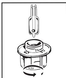
**U kunt de lamp zelf vervangen wanneer deze niet meer werkt.** Schroef het venster en daarna de lamp los (gebruik een rubber handschoen, die de demontage zal vergemakkelijken). Plaats de nieuwe lamp en zet het venster terug.
