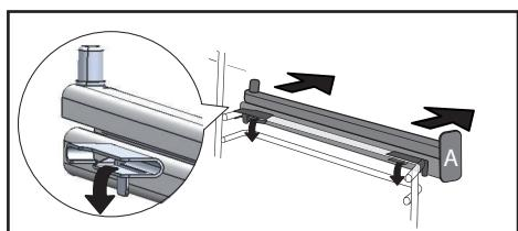
**ПРИМЕЧАНИЕ.** Выдвижная часть направляющей должна раздвигаться в сторону передней части духового шкафа, упор  $\textcircled{A}$  находится напротив вас. Установите на место 2 проволочные решетки и затем положите противень на 2 направляющие — система готова к использованию.
