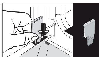
Extraiga el primer cristal enganchado: Con la ayuda de otra cuña (o de un destornillador) presione en las ranuras A
