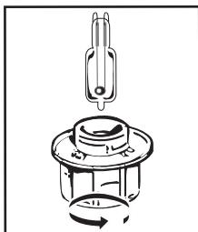
**Puede cambiar la bombilla usted mismo cuando deje de funcionar.** Desatornille el plafón y extraiga la bombilla (utilice un guante de goma que facilitará el desmontaje). Introduzca la nueva bombilla y vuelva a instalar el plafón.
