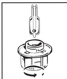
Ak žiarovky nefungujú, môžete ich vymeniť sami. Zložte tienidlo a potom odskrutkujte žiarovku (použite gumenú rukavicu, ktorá uľahčí vymontovanie). Namontujte novú žiarovku a nasadťte späť tienidlo.
