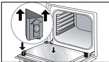
Tras la limpieza, vuelva a colocar los cuatro topes de goma con la flecha hacia arriba y coloque de nuevo los cristales.
