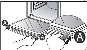
отщелкнуть стекло. Снимите стекло. Дверца состоит из двух дополнительных стекол, на каждом углу которых находится по черной резиновой соединительной стойке.
