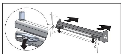
**ΣΗΜΕΙΩΣΗ:** το συρόμενο τηλεσκοπικό μέρος της ράγας πρέπει να ξεδιπλώνεται προς το μπροστινό μέρος του φούρνου, ενώ το στοπ  $\textcircled{A}$  βρίσκεται απέναντι σας. Τοποθετήστε τις 2 ράγες στήριξης ταψιών στη θέση τους και, στη συνέχεια, τοποθετήστε το ταψί στις 2 συρόμενες ράγες, το σύστημα είναι έτοιμο να χρησιμοποιηθεί.
