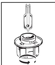
Якщо лампочка перестала працювати, ви можете самостійно замінити її. Зніміть захисне скло та зніміть лампочку, використовуючи гумову рукавичку, яка полегшує процес демонтажу. Вставте нову лампочку та встановіть на місце захисне скло.
