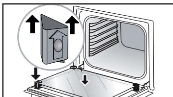
Po zakończeniu czyszczenia należy ponownie założyć cztery gumowe ograniczniki ze strzałką skierowaną do góry i zamontować wszystkie szyby.
