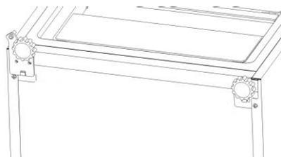
7. Installez la charnière centrale à la position de montage gauche et installez le couvercle de vis précédemment retiré dans le trou de vis droit.
