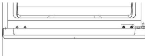
3. Poser le réfrigérateur et retirer la charnière inférieure et l'angle de mise à niveau au bas du réfrigérateur.
