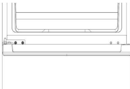
8. Installez la porte, connectez les bornes, installez la charnière supérieure, le couvercle de charnière supérieur et le couvercle de vis retiré précédemment. Porte arrière terminée. (la charnière supérieure et le cache de charnière sont installés à gauche comme indiqué sur la figure, et le cache-vis est à droite)
