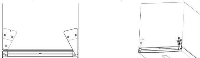
2. Retirez les vis de la charnière du milieu avec un tournevis cruciforme, retirez la charnière du milieu, retirez le couvercle de la vis au niveau du trou de vis gauche et retirez la porte inférieure.
