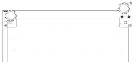
4. Retirez le cache-fils du cache supérieur de la porte supérieure, changez le faisceau de câbles du côté droit au côté gauche, installez le cache-fils du cache d'extrémité supérieur et changez la porte supérieure et la butée de porte inférieure du côté gauche. (Le remplacement de la porte supérieure et de la butée de porte inférieure est le même que celui de la porte inférieure, et le
