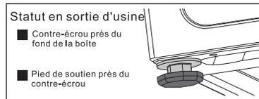
**⚠ Remarque :** il se peut que les pieds ne soient pas complètement verrouillés en sortie d'usine, assurez-vous de verrouiller les quatre pieds avant de régler le niveau !
