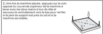
2. Une fois la machine placée, appuyez sur le coin opposé du couvercle supérieur de la machine à laver avec les deux mains à tour de rôle et secouez-le verticalement vers le bas pour vérifier si le pied de support est près du sol et si la machine est stable.
