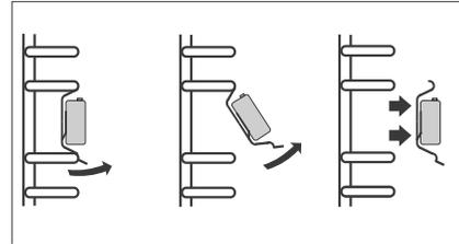
Démontage des rails télescopiques
