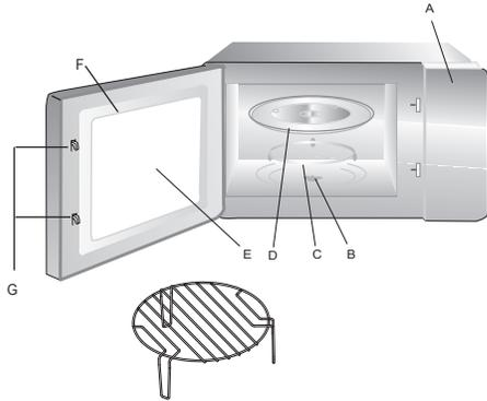
Grille : s'utilise uniquement avec la fonction Gril et doit être placée sur le plateau en verre.
