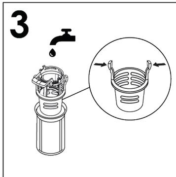
● Retirer la plaque métallique (fig.4) et laver l'ensemble du système de filtrage sous le robinet d'eau (fig.5). Si nécessaire, une petite brosse peut être utilisée.
