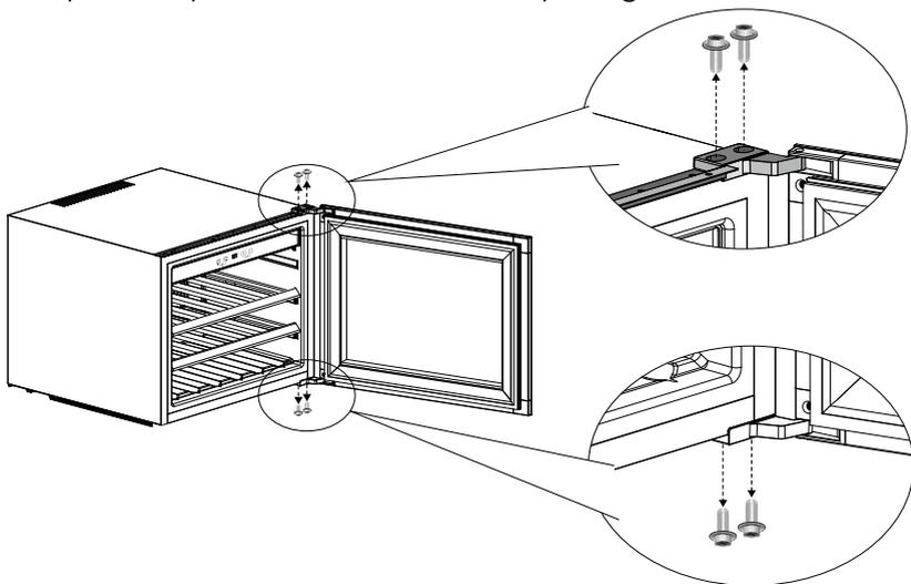
o Dévissez les 3 vis du support du haut, déplacez ce dernier du côté droit et vissez les 3 vis.
