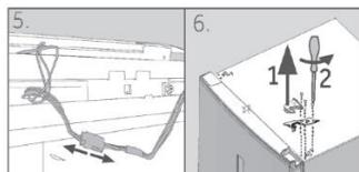
6. Soulevez soigneusement la porte du réfrigérateur démontée de la charnière inférieure.
