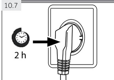
L'huile d'entretien du compresseur se trouve dans la capsule du compresseur. Cette huile peut se déverser dans le circuit fermé du système pendant le transport. Avant de brancher l'appareil à l'alimentation électrique, vous devez attendre 2 heures (Fig. 10.7) pour permettre à l'huile de retourner dans la capsule.
