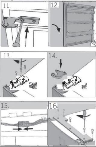
11. Sortez la nouvelle charnière inférieure de la porte supérieure du sac contenant les accessoires et vissez-la sur le côté gauche de l'appareil.
