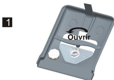
Étape 1: tournez le dispositif de filtrage dans le sens contraire des aiguilles d'une montre,
