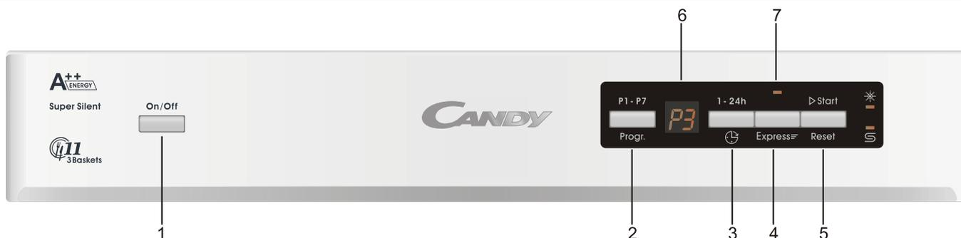
1. Bouton et voyant Marche/arrêt : le bouton permet d'allumer/éteindre l'appareil ; le voyant s'allume quand l'appareil est allumé.
