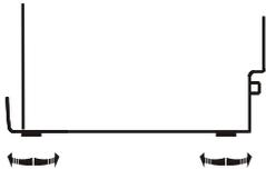
Une fois l'appareil positionné pour être mis de niveau, vous pouvez ajuster sa hauteur à l'aide de la vis de réglage de la hauteur des pieds.
