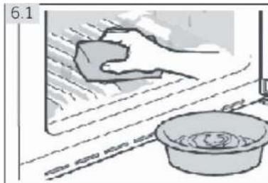
1. Frottez l'intérieur et l'extérieur du congélateur, y compris le joint de porte, les balconnets de la porte, les clayettes en verre, les boîtes à aliments, etc., avec une serviette ou une éponge souple trempée dans de l'eau chaude (vous pouvez ajouter un détergent neutre dans l'eau chaude).
