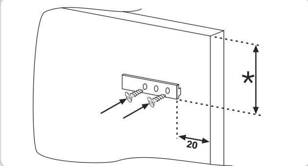
Ouvrir les portes de la colonne encastrée et du réfrigérateur. Positionner le support encastré dans la glissière, et ensuite l'introduire dans la porte du réfrigérateur.
