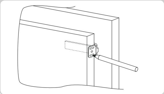
Raccorder la porte de l'appareil avec le panneau du cabinet en se servant des rainures du support comme lignes directrices.
