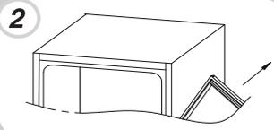
Retirer la charnière inférieure droite et les bouchons plastiques de gauche et les remettre en place sur le côté opposé.
