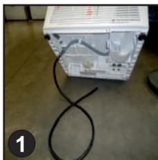
2. O tubo de drenagem de águas está situado no lado direito da máquina (veja a imagem). Uma mangueira cinza liga-se do lado esquerdo da máquina. Com a ajuda de um alicate, remova o clip de retenção do tubo de ligação.
