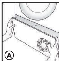
2. Puxe o punho com firmeza e faça deslizar o recipiente da água para fora da máquina. **(B)** Segure o recipiente com ambas as mãos. **(C)** Quando cheio, o recipiente da água pesa aproximadamente 4 kg.
