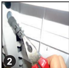
3. Trek de slang los van de brugverbinding.
