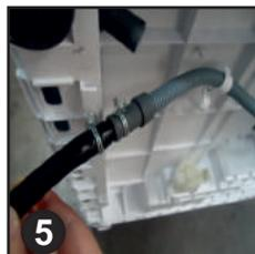
6. Una volta che la macchina è in posizione, verificare all'estremità inferiore che il nuovo raccordo non si attorcigli quando si riposiziona l'essiccatrice.
