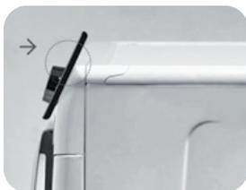
**Si vous ne savez pas où se situe l'antenne NFC sur votre smartphone, faites de lents mouvements circulaires autour du logo Smart Touch jusqu'à ce que l'application Simply-Fi confirme la connexion. Afin de garantir une connexion stable, il est important de GARDER LE SMARTPHONE SUR LE LOGO Smart Touch PENDANT LA PROCÉDURE D'APPAIRAGE ET PENDANT LE PHASES DE SYNCHRONISATION. L'application Simply-Fi vous avertira lorsque vous pourrez retirer votre smartphone du logo Smart Touch.**
