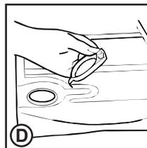
5. Plaats de beschermplaat terug door de bovenkant terug in de hengsels te bevestigen en het onderste gedeelte terug op zijn plaats te 'klikken'.
