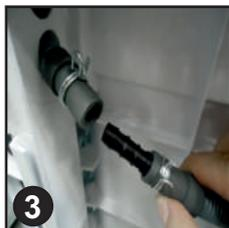
4. Fissare il raccordo nero del set, (utilizzando il connettore e i ganci per i tubi forniti), al raccordo rimosso dal collegamento a ponte.
