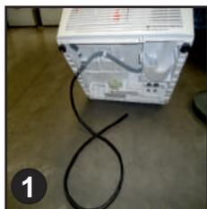
2. El tubo de desagüe está ubicado en el lado derecho del aparato (ver imagen). Una manguera gris conecta con el puente al lado izquierdo del aparato. Retire el tubo de la abrazadera de sujeción utilizando unas pinzas.
