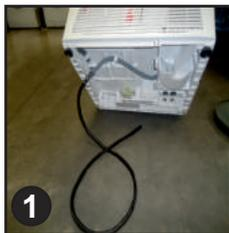
2. Il tubo dell'acqua di scarico è situato sul lato destro della macchina (vedi immagine). Utilizzando un paio di pinze, togliere il collare di fissaggio del tubo dal ponte che si trova più vicino al lato posteriore della macchina.
