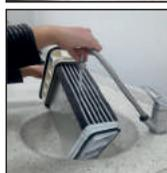
5. Bitte überprüfen Sie den korrekten Sitz der Dichtungen nach dem Reinigen und bringen diese ggf. wieder an der dafür vorgesehenen Position an.
