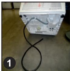
2. De leiding voor het afvalwater is gelegen aan de rechterkant van de machine (zie afbeelding). Een grijze slang verbonden met de brug aan de linkerkant van de machine. Verwijder de buis die wordt vastgehouden in de klem van de brug, met een tang.
