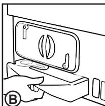
Halten Sie den Behälter mit beiden Händen. (C) Im gefüllten Zustand wiegt der Kondenswasserbehälter rund 4 kg.
