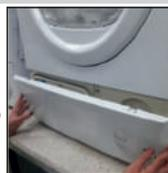
2. Agire sulle due leve di bloccaggio in senso antiorario e estrarre il condensatore.
