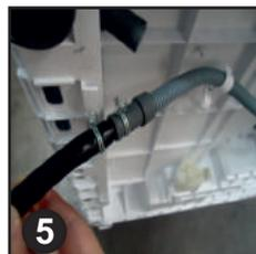
6. Depois da máquina estar no lugar, verifique o fundo para se assegurar de que a mangueira nova não fica dobrada ao empurrar a máquina de secar roupa para a posição definitiva.
