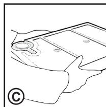
4. Vuelva a poner la tapa de nuevo y reinstale el recipiente para agua, deslizándolo hasta que entre en su posición. (D) **P R E S I Ó N E L O F I R M E M E N T E H A S T A Q U E E N T R E E N S U P O S I C I Ó N .**
