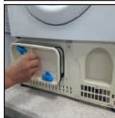
4. Entfernen Sie etwaigen Staub oder Flusen vorsichtig mit einem Tuch, reinigen Sie das Teil danach unter laufendem Wasser, wobei Sie es so drehen, dass das Wasser zur Entfernung von Staub und Flusen zwischen die Platten laufen kann.
