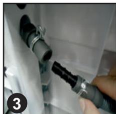
4. Acopla la manguera negra del kit (utilizando el conector y las abrazaderas de sujeción suministradas) a la manguera retirada del puente de conexión.
