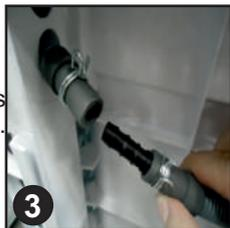
4. Bevestig de zwarte slang van de kit (met de stekker en bevestigingsclips geleverd), met de slang uit de brugverbinding.
