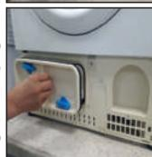
4. Servendosi di un panno, eliminare delicatamente polvere e filacce, poi lavare il modulo tenendolo sotto l'acqua corrente e facendolo girare in modo che l'acqua circoli tra le piastre fino a perfetta eliminazione delle impurità
