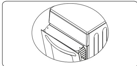
Tenir la protection thermique avec les avertissements vers le haut. Le bord arrière de la protection thermique comporte deux doubles rainures à droite et à gauche (voir figure).
