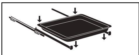
Pour démonter les rails, retirez à nouveau les gradins-fils.
