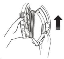
Open the baffle first, and then pour out the dust.
