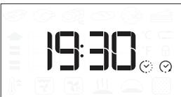
Veillez noter : La programmation d'un délai pour le début de la cuisson désactive la phase de préchauffage. Le four va atteindre la température désirée graduellement, ce qui signifie que les temps de cuisson vont être légèrement plus longs que ceux indiqués sur le tableau de cuisson.
