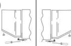
Retirez les caches (A) et (B), desserrez les vis et enlevez partiellement le bandeau.
