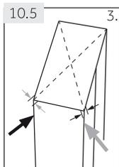
Assurez-vous que la distance vers le mur sur le côté de la charnière de la porte est d'au moins 100 mm pour permettre à la porte de s'ouvrir aisément.
