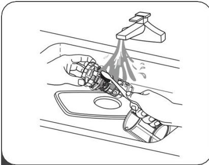
**3** Rincez le filtre sous l'eau du robinet pour en retirer les principaux résidus alimentaires. Pour un nettoyage plus efficace, utilisez une brosse de nettoyage non abrasive.
