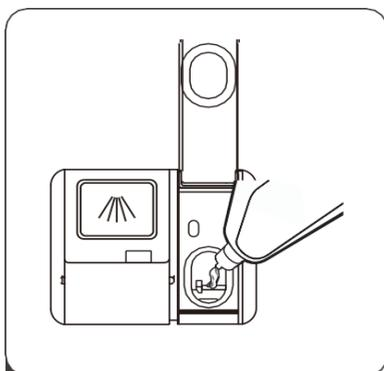
**2** Versez le produit de rinçage dans le réservoir en veillant à ne pas dépasser le niveau maximum.
