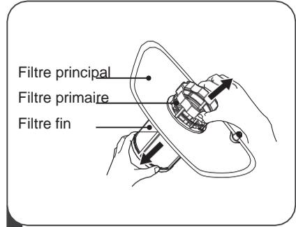
**2** Vous pouvez retirer le filtre fin situé en bas du dispositif de filtration. Démontez le filtre primaire du filtre principal en appuyant délicatement sur les languettes situées en haut avant de retirer le filtre.
