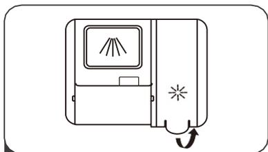
**1** Retirez le couvercle du bac à produit de rinçage en tirant sur la poignée.
