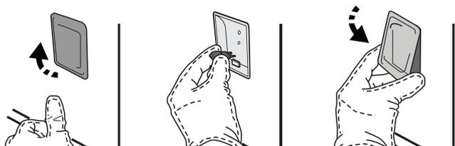
Veillez noter : Utilisez uniquement des ampoules à halogène de 20-40 W/230 ~ type V G9, T300°C. L'ampoule utilisée dans l'appareil est spécialement conçue pour les appareils électroménagers et ne convient pas pour l'éclairage d'une pièce de la maison (Règlement CE 244/2009). Ces ampoules sont disponibles auprès de notre Service Après-vente.
