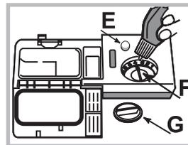
1. Ouvrir le réservoir en tournant le couvercle « G » dans le sens inverse des aiguilles d'une montre.
