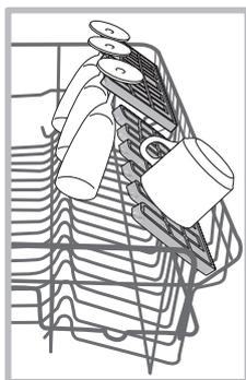
Les verres à pied peuvent être placés en position stable sur les clayettes rabattables en insérant leurs pieds dans les fentes prévues à cet effet.
