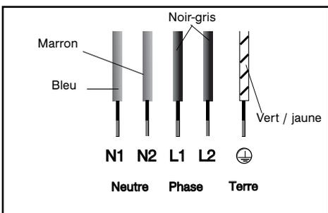
Lors d'un branchement 400 V 2N triphasé, vérifiez que le fil neutre est bien connecté.
