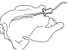
Pour la volaille, la sonde doit être insérée sur les côtés, au milieu de la poitrine, en veillant à ce que le bout de la sonde n'aboutisse pas dans une partie creuse. Si l'épaisseur de la viande est irrégulière, contrôler qu'elle est cuite correctement
