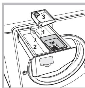
plus résistantes. Possibilité d'utilisation avec ou sans eau de Javel. Pour effectuer un blanchiment aussi, il faut introduire le bac supplémentaire 3, fourni, dans le bac 1. Au moment de verser l'eau de Javel, attention à ne pas dépasser le niveau "max" indiqué sur le pivot central (voir figure).
