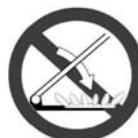
Appareils avec couvercle verre (suivant modèle) : le couvercle en verre peut éclater lorsqu'il est chauffé. Veuillez éteindre tous les brûleurs avant de fermer le couvercle.
