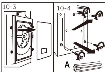
3. Remplacez le couvercle arrière en l'insérant dans les deux interstices, avec la convexité orientée vers l'extérieur (Fig. 10-3).
