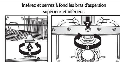
Insérez et serrez à fond les bras d'aspersion supérieur et inférieur.
