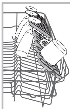
Les verres à pied peuvent être placés en position stable sur les clayettes rabattables en insérant leurs pieds dans les fentes prévues à cet effet. Pour optimiser le séchage, choisir la plus forte inclinaison des clayettes rabattables. Pour modifier l'inclinaison de la clayette rabattable, la soulever et la faire glisser légèrement avant de la placer comme voulu.
