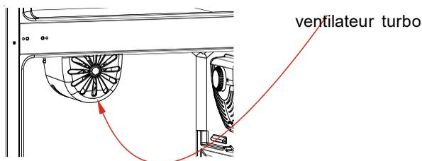
Évitez d'obstruer les orifices d'entrée et de sortie d'air au moment de conserver les aliments. Si vous le faites, la circulation de l'air rendue possible par le ventilateur turbo sera défaillante.
