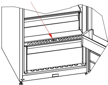
Si le compartiment à légumes est plein, le curseur de fraîcheur situé à l'avant du compartiment à légumes doit être ouvert. Lorsque vous l'ouvrez, la température et l'humidité de l'air du compartiment à légumes diminuent.
