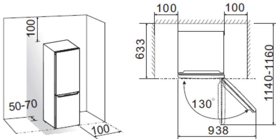
**- Cet appareil doit être installé de façon à ce que la prise de courant reste accessible. Assurez-vous après l'avoir installé qu'il ne repose pas sur le câble d'alimentation.**
