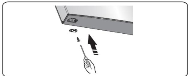
9. Changez le positionnement du cache du trou de la vis (sur la plaque de recouvrement intermédiaire) en le faisant passer de gauche à droite (comme sur l'illustration suivante).
