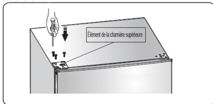
17. Installez le cache de la vis sur le côté droit du réfrigérateur. Installez le cache de la charnière supérieure (fourni dans le sachet), côté gauche. Placez l'autre cache supérieur dans le sachet plastique.
