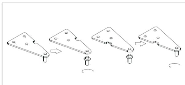
8 Remontez la porte et la charnière supérieure sur le côté gauche. Assurez-vous que la porte soit bien alignée, de sorte que les joints soient compressés sur tous les côtés avant de fixer la charnière supérieure. Si nécessaire, utilisez une clé pour serrer la charnière.
