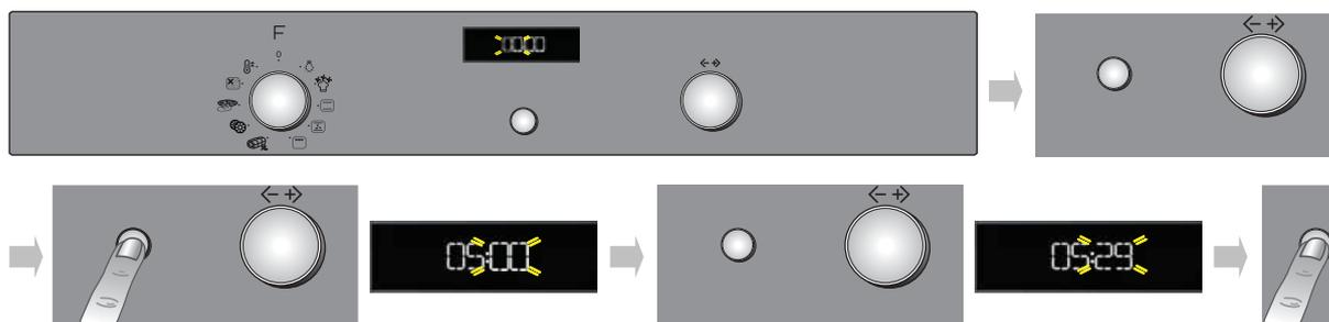
Après le réglage de la langue, il est nécessaire de régler l'heure. Les deux chiffres relatifs à l'heure clignoteront sur l'afficheur.
