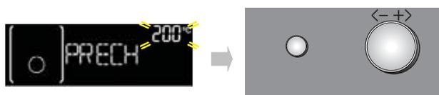
1. Sélectionnez la fonction Préchauffage rapide en tournant le bouton « Fonctions » en face du symbole
